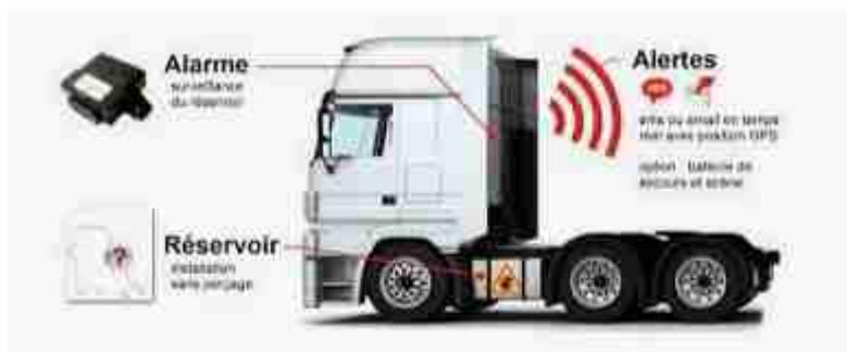
Le principe consiste à détecter une baisse anormale de carburant dans le réservoir qui est provoqué par un siphonnage, un perçage de réservoir ou encore par le démontage de la jauge.
